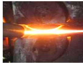
Milling (tube forming, ERW)
